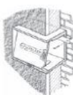
« illustration 2 : encastré dans la couche isolante à l'aide de la barre de support »
